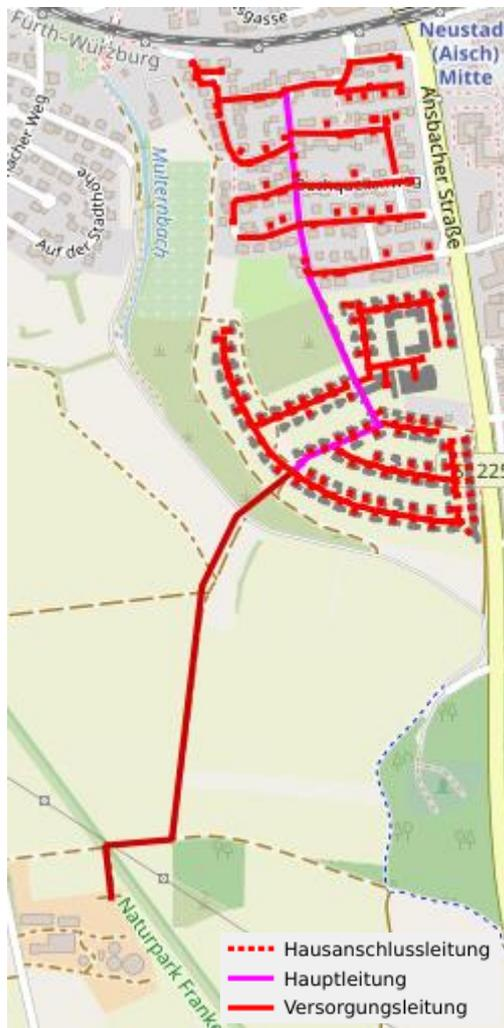
Abbildung 15: Schematischer Wärmenetzverlauf mit Zuleitung der Biogasanlage [www.openstreetmap.org]
